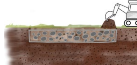
La tranchée drainante
