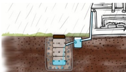
Le puits d'infiltration
