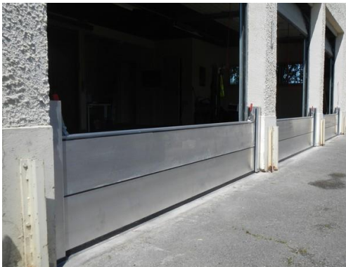
Exemple de batardeau (source : Hydroprotect)
