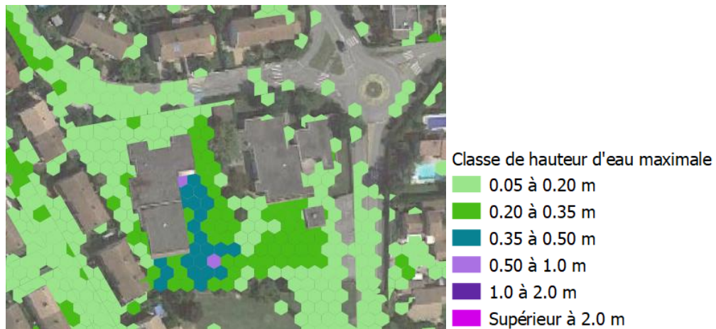
Figure 40 Inondation de l'école
