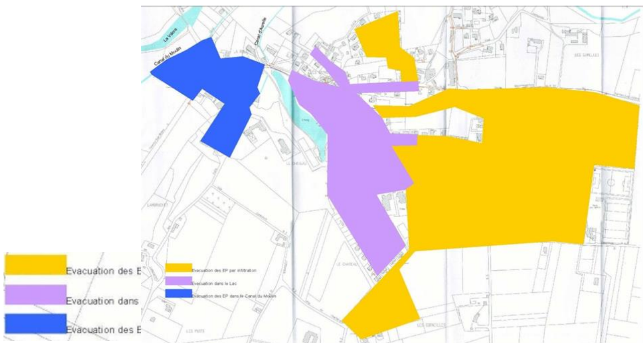
Figure 28 - Exutoires des eaux de pluies
